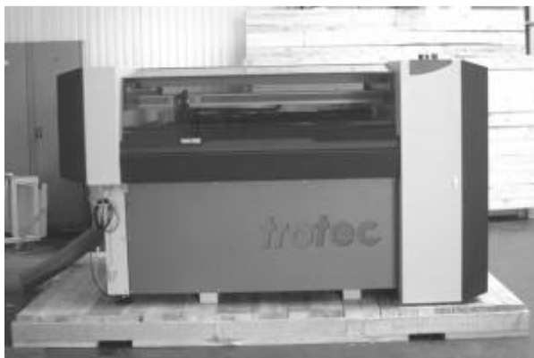
Le système SP1500 est maintenu en position par des espaceurs en bois
