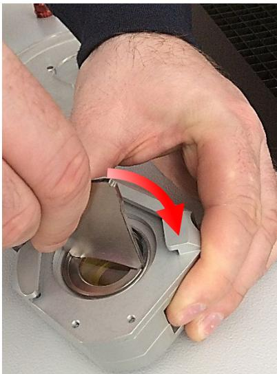
7. À l'aide de l'outil essentiel fourni, desserrez la bague de serrage en tournant dans le sens des aiguilles d'une montre.
