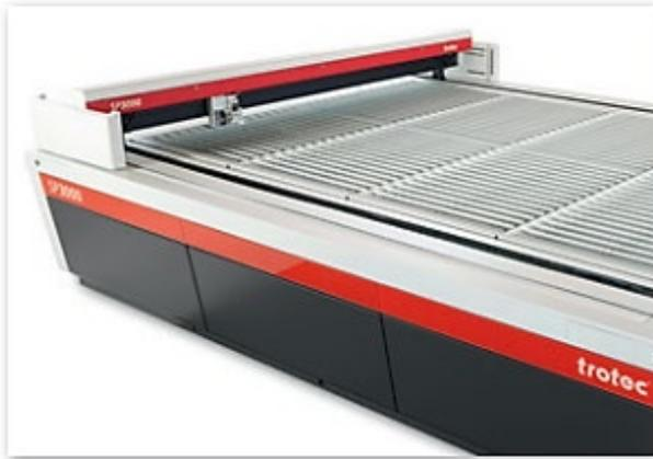
Le plateau de découpe à lames en aluminium s'emploie principalement pour les coupes de matériaux plus épais (jusqu'à 8 mm d'épaisseur) et pour les pièces dont la largeur est supérieure à 100 mm. L'acrylique peut être découpé sans réflexions en remplaçant les lames en aluminium par des lames en acrylique. Afin de réduire le nombre de points d'appui, il est possible de retirer certaines lames en fonction de la tâche à réaliser.
