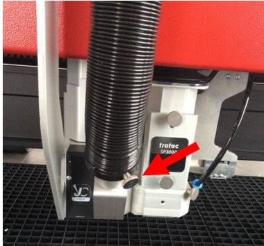
1. Dévissez la vis de fixation et retirez le flexible d'extraction. (1 vis)
