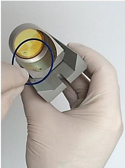
7. Retirez la bague de serrage et la bague d'étanchéité.
