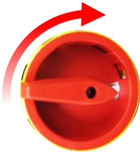
5. Allumez l'alimentation principale de la machine en tournant l'interrupteur principal dans le sens des aiguilles d'une montre. L'interrupteur principal est situé à l'avant de la machine sur le côté droit.
