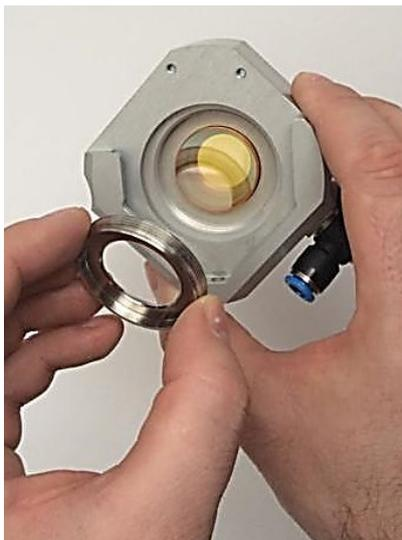
8. Retirez la bague d'étanchéité.
