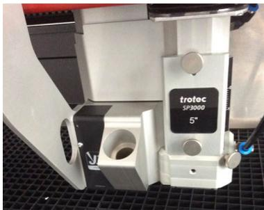
2. Nettoyez le conduit du flux d'air et le point de raccordement.
