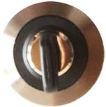
Le fait de tourner l'interrupteur à clé dans le sens inverse des aiguilles d'une montre coupe le moteur, la source laser et le système électrique.
