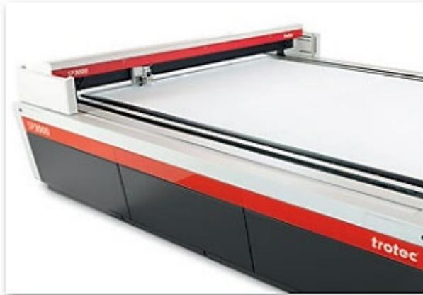
Plateau de découpe universel pour la découpe sans réflexion d'acrylique de fine épaisseur jusqu'à 8 mm. Tout comme pour le plateau avec grille de découpe en aluminium, les pièces inférieures à 100 mm restent à plat après la découpe.
