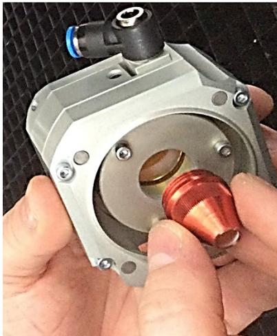
6. Tournez la buse dans le sens des aiguilles d'une montre pour pouvoir la retirer.
