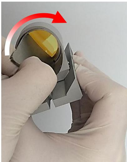
6. À l'aide de l'outil essentiel fourni, desserrez la bague de serrage en tournant dans le sens des aiguilles d'une montre.
